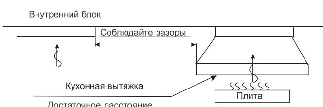
Кухня должна быть оснащена вытяжкой вентиляцией такой мощности, чтобы масло, пар, мука и частицы продуктов выводились из помещения и не оседали на узлах кондиционера.
