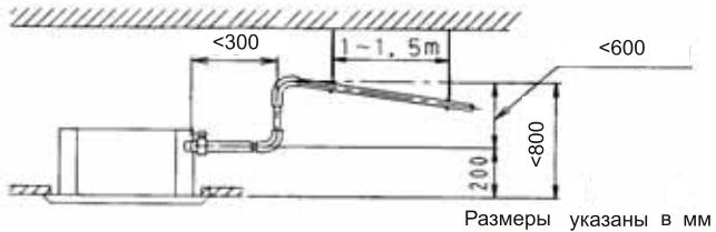
3. Если к одной линии отвода конденсата подключено несколько блоков, то она должна проходить на 100 мм ниже дренажного отверстия каждого блока (см. рис. справа).
