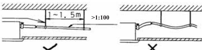
2. Агрегат оснащен дренажным насосом, который поднимает конденсат на высоту до 1200 мм. Однако после останова насоса вода, находящаяся в линии, может стечь назад и переполнить дренажный поддон. Дренажная линия должна прокладываться в соответствии с иллюстрацией.
